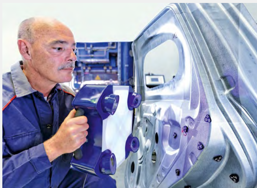
3D-Scan einer Autotür zur Überprüfung des Umformverhaltens
