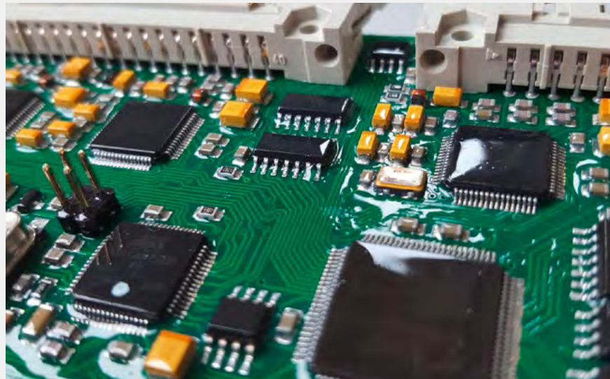
Eine Spezialität von Phoenix PHD ist die Fertigung von hochkomplexen Elektronik. Kleinste zur fertige Komponente 0201.
