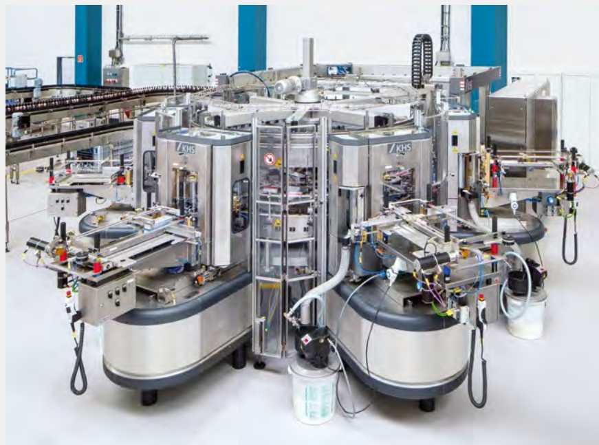
Die Innoket Neo – verschiedene Etikettier-techniken in einer Maschine vereint.
