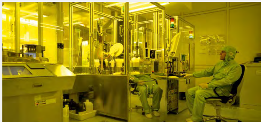
Im Reinraum erfolgt ein Lithographieschritt an Sensorwafern.
