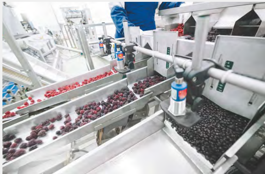
Regulierung des Volumenstroms in der Lebensmittelindustrie dank Ultraschallsensoren
