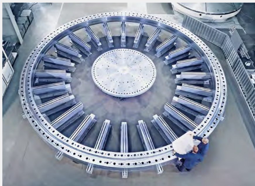
Ringfertigung im Werk Dortmund
